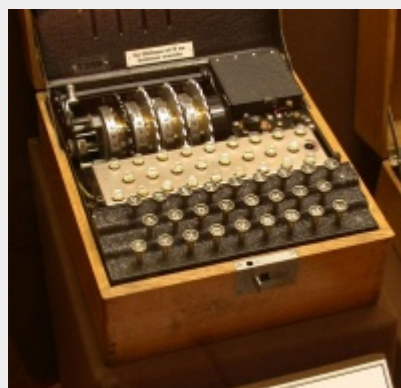
Enigma, la macchina cifrante elettromeccanica
